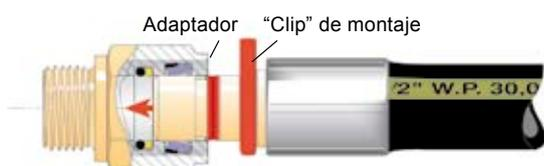
3. Presione la espiga hasta que toque el "clip" de montaje.
