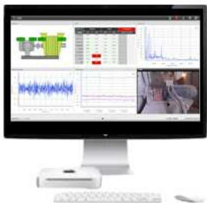
Con iPdM recibirá las alarmas en el instante en el cual se alcanzan los niveles de alerta o alarma en los parámetros monitorizados en las máquinas.
